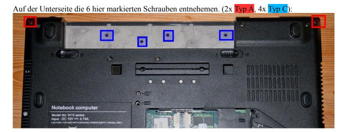
Bei den kleinen Schrauben unter dem Akku (4x Typ C) muss man besonders vorsichtig vorgehen und darauf achten einen passenden Schraubendreher zu verwenden der exakt sitzt. Sonst zerstört man die Schraube beim Drehversuch und muss (so wie es mir passiert ist) die Schraube aufbohren.
