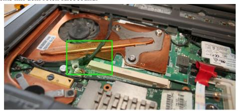
Unter Buttonboard-Abdeckung zwei Schrauben (2x Typ D) entfernen:
