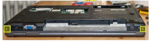
Im DVD-Laufwerksschacht müssen auch zwei Schrauben (2x Typ B) entfernt werden:
