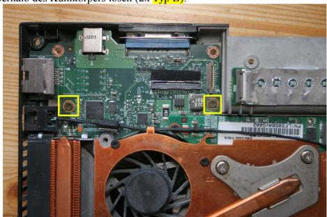
Nun kann das Mainboard entnommen werden wobei man den VGA-Ausgang und der Firewire-Port vorsichtig aus der Unterschale quetschen muss:
