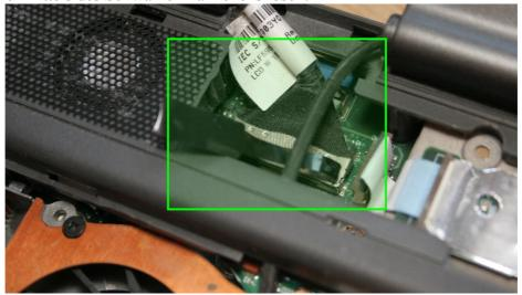
Die Antennenkabel müssen vom WLAN-Adapter gelöst werden. Die Steckerchen möglichst gerade und ohne seitlichen Druck nach oben abziehen. Sie sind nicht für viele Steckvorgänge gedacht und mechanisch nicht sehr belastbar, daher sollten sie mit Vorsicht behandelt werden:
