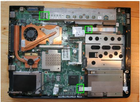
Schrauben oberhalb des Kühlkörpers lösen (2x Typ B):
