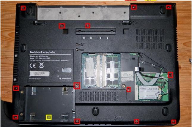
Auf der Rückseite die hier markierten Schrauben (2 x Typ B) entfernen:
