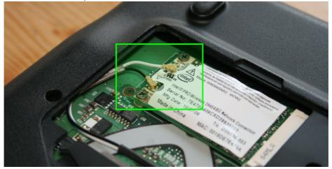
Sind die Kabel von dem WLAN-Modul gelöst müssen sie durch das Gerät gezogen werden (Grüne Markierung im Foto unten) um das Oberteil samt Display nachher problemlos abnehmen zu können. Das kleine Flachbandkabel vom Touchpad muss entfernt werden. Auf dem Foto unten ist es das Kabel rechts mit dem roten Klebeband:
