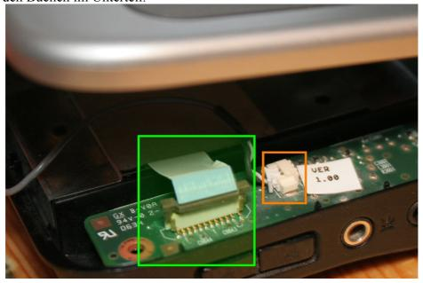
Im folgendem Bild ist das Kabel der LED-Leiste markiert das gelöst werden muss. Links davon befindet sich der Stecker für das Bluetooth-Modul (im Foto ohne Kabel) welches zum abnehmen der Oberschale nicht gelöst werden muss, da es auf dem Mainboard verklebt ist:
